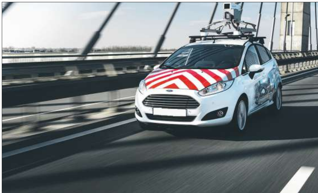
Aufnahmetechnik. Der Ford Fiesta ist mit einem speziellen Kameraufbau ausgerüstet.
