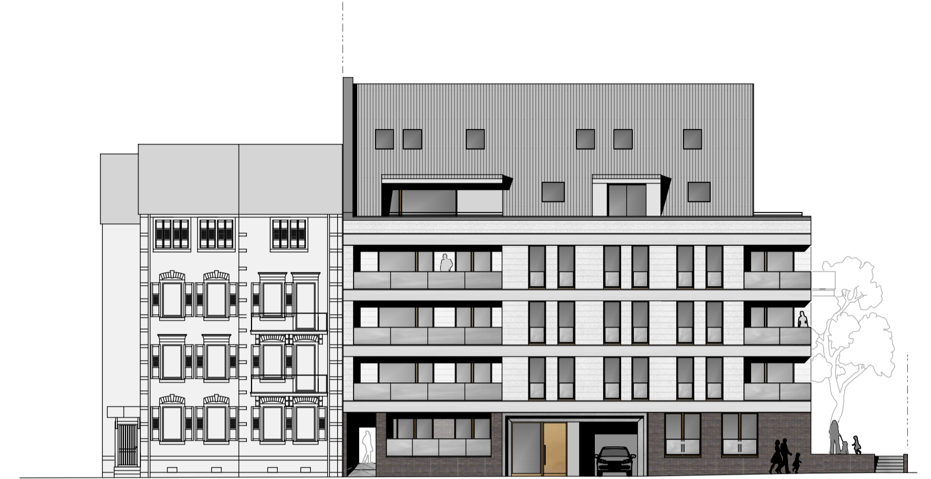
Ansicht West Neubau (Straßenansicht Eingang MFH) M 1/200
