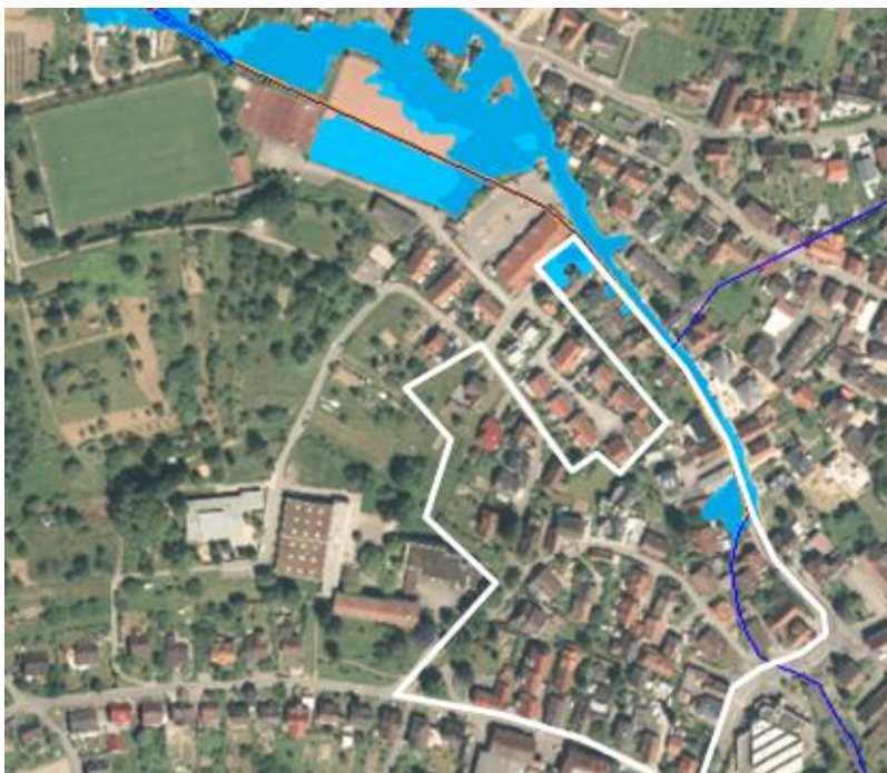
Abb. 3: Der Dorfbach (blaue Linie) im Bereich des Bebauungsplans „Winkel 2“ (weiße Umrahmung). Die Verdolung ist als orangene Linie dargestellt. Die hellblaue Fläche zeigt die überschwemmten Gebiete bei einem HQ 100 Ereignis, während der blaue Flächenanteil den überschwemmten Bereich bei einem HQ 50 Ereignis darstellt.
